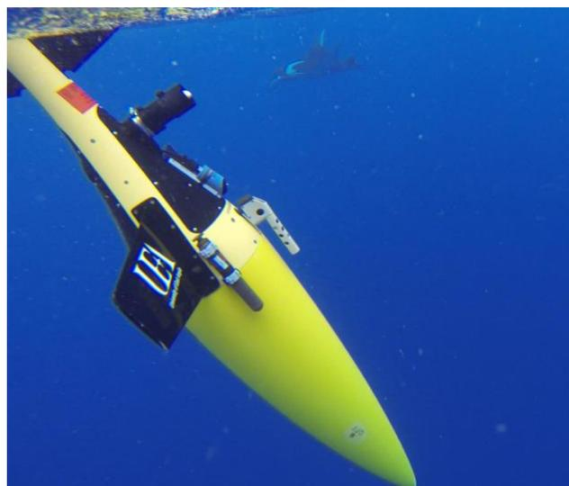
Trajectoires des *gliders* ABACUS à travers le bassin algérien, et photo sous-marine d'un *glider* équipé d'un hydrophone.
